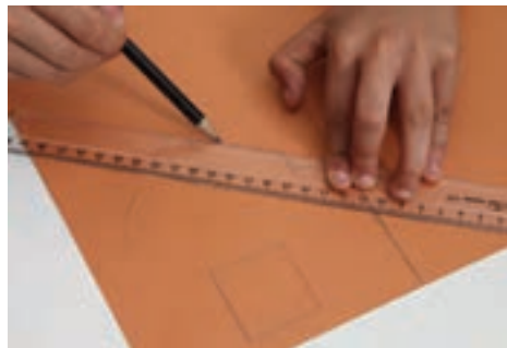
الف - ترسیم نقشه بدنه خودرو روی مقوا (عرض بدنه می‌بایست کمی بیشتر از اندازه طول کس لاستیکی باشد.)
