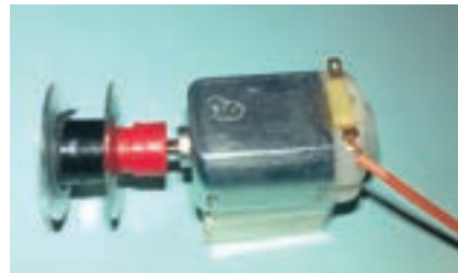
الف- تاباندن و محکم کردن سیم
