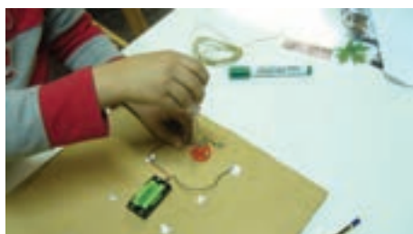
ح - اتصال سرپیچ لامپ به بدنه
