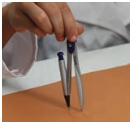
ب- ترسیم دایره روی مقوای فشرده با استفاده از پرگار با شعاع ۱۵ میلی‌متر
