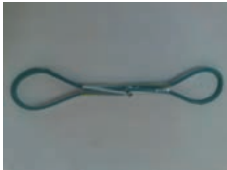
ث- پیچیدن مفتول برای ثابت کردن کش در لوله
