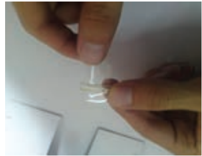
الف – یک تکه لوله پلاستیکی ( حدود ۲ سانتی متر ) را با چسب شفاف به قسمت تا شده جای قرقره بچسبانید .
