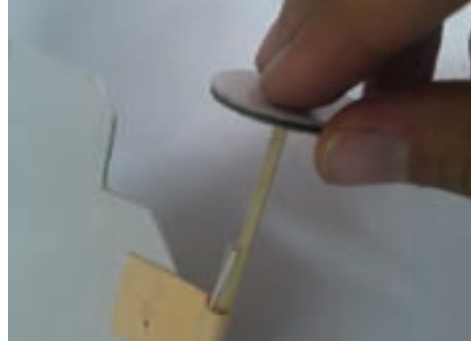
الف- عبور محور چوبی از یاتاقان‌ها
