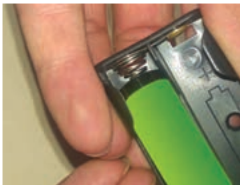
ب- قرار دادن باتری قلمی اول در جای باتری به طور صحیح
